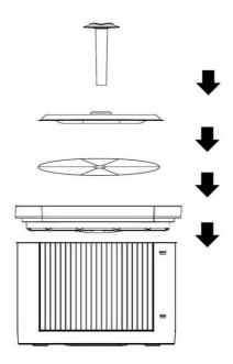
4. 順次序將水箱頂蓋、水箱濾網、金屬儲水盤及出水管逐一安裝於水箱,配件組裝完成。
