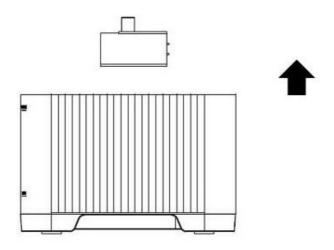
2. 向上提起水箱頂蓋後,取出水泵並清除水箱内的食水。 **備注:**水箱及水泵需定時清潔,建議每週清洗一次。
