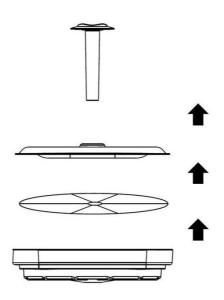
1. 向外提起出水管及金屬儲水盤,以更換水箱濾網。
