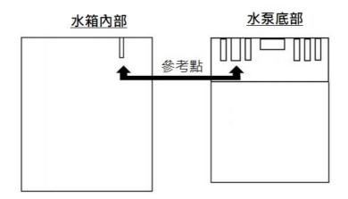
2. 参考上圖,將水泵底部的参考點對準水箱內的卡槽。
