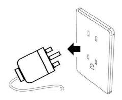
從插座拔出適配器,並由水箱的底部取出 USB 供電底座,以 斷絕電源供應。
