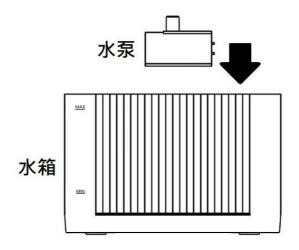
1. 將已清潔的水泵,安裝於水箱内部的卡槽位置。
