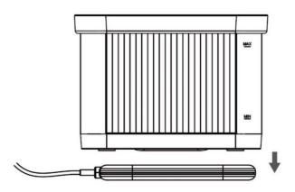
3. 完成水箱與配件的安裝後,將水箱平穩放置於 USB 供電 底座上。
